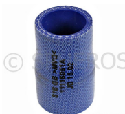
Siliconeslange D1i 35 mm, D2i 38 mm, D1a 44 mm, D2a 47 mm, L 70
